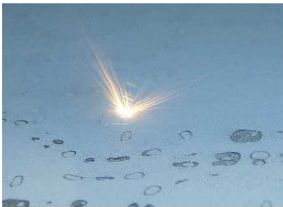
Abb. 9: Schichtweise Aufschmelzen von Metallpulver zu Zahnversorgungen.
