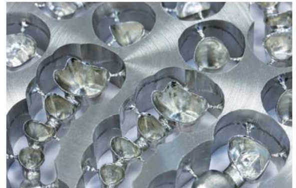
Abb. 10: Per Fräsverfahren können auch sehr feine Konturen erzielt werden.
