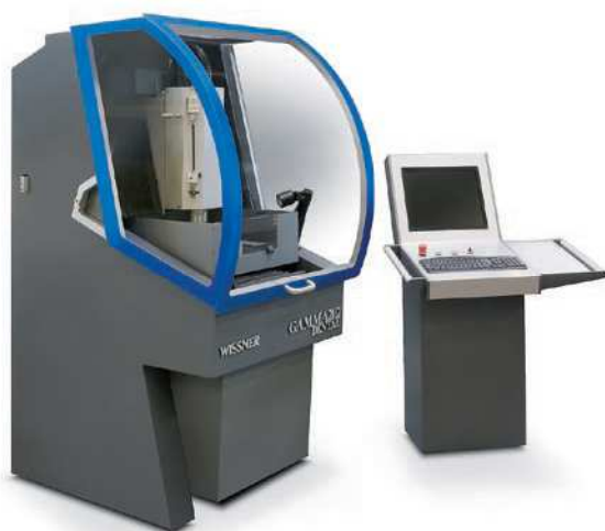
Abb. 11: HSC-Maschine mit hoher Steifigkeit.
